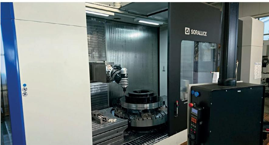
FMT 4000 für Dreh- und Fräsarbeiten
